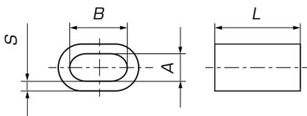
Алюминиевые втулки, стандарт EN13411-3 (DIN3093), представлены типоразмерами от 2,5 до 8,0 для опрессовки стальных тросов.
