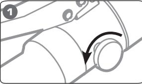
**1** Поверните винт сброса давления в положение «Открыть».
