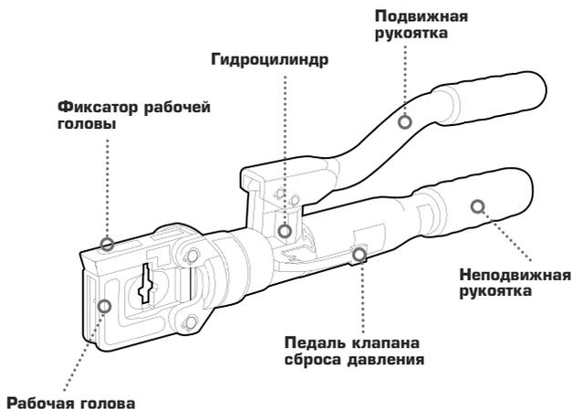
Пресс гидравлический **ПГРс-240А** состоит из рабочей головы с пазами для установки матриц, гидроцилиндра, встроенного двухступенчатого плунжерного насоса, а также корпуса, подвижной и неподвижной рукояток выполненных из легкого алюминиевого сплава.
