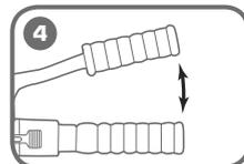
**Нажимая на подвижную рукоятку, создайте давление до срабатывания клапана АСД и автоматического возврата штока**
