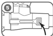
**В случае окончания рабочего цикла до срабатывания клапана АСД, нажмите на педаль сброса давления и извлеките опрессованное изделие**
