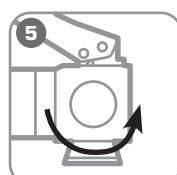
Поверните винт сброса давления в положение «Открыть»
