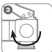
Поверните винт сброса давления в положение «Закрыть»
