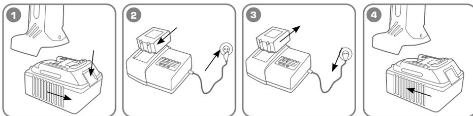
**1** Для снятия аккумулятора, нажмите на фиксатор и выньте его из корпуса инструмента.
