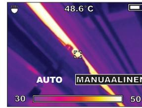
Näyttöön saatu kuva voidaan ottaa katkaisupainikkeella. Toistamiseen painamalla kuva tallennetaan SD-muistikortille.
