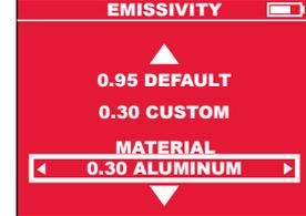
Тези настройки посочват на термовизионната камера, какъв материал ще бъде измерван. Настройката на правилния коефициент на излъчване е важна и оказва решаващо влияние върху точността на температурното измерване. В таблицата
