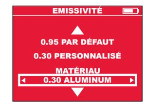
Ces saisies communiquent à la caméra thermique le matériau à mesurer. Il est très important de sélectionner le juste degré d'émission car il influence de façon significative la précision du mesurage de la température. Dans la table suivante on a dressé la liste des différents matériaux et des respectives valeurs d'émission.
