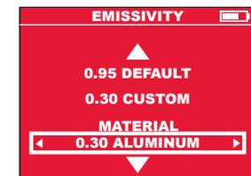
Οι ρυθμίσεις αυτές ενημερώνουν τη θερμική κάμερα, ποιο υλικό οφείλει να μετρηθεί. Η ρύθμιση του σωστού συντελεστή εκπομπής είναι σημαντική και έχει μια σημαντική επίρροη στην ακρίβεια της μέτρησης θερμοκρασίας. Στον ακόλουθο πίνακα απεικονίζονται τα διάφορα υλικά και οι αντίστοιχες τιμές εκπομπής.
