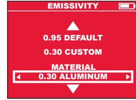
此调整向热像相机通知要测量哪个材料。为获得高精度的温度测量应调整正确的发射率。不同材料和相应发射数值列出在下列表中。
