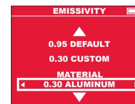
Tieto nastavenia oznamujú termovíznej kamere, ktorý materiál sa má merať. Nastavenie správnej emisivity je dôležité a má významný vplyv na presnosť merania teploty. V nasledujúcej tabuľke sú spísané rozličné materiály a príslušné emisné hodnoty.
