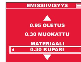
Näillä asetuksilla lämpökameralle ilmoitetaan, mitä materiaalia halutaan mitata. Oikean emissioarvon asetus on tärkeä ja sillä on ratkaiseva merkitys lämpötilanmittauksen tarkkuudelle. Seuraavassa taulukossa luetellaan eri materiaalit ja niiden vastaavat emissioarvot.
