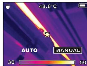
Pomocí spínacího tlačítka se dá nasnímat zobrazený snímek. Opětovně stisknutí uloží snímek na SD kartu.
