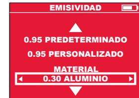
Estos ajustes le indican a la cámara termográfica qué material de la superficie debe ser medido. El ajuste de la emisividad correcta tiene una influencia significativa sobre la exactitud de las lecturas de temperatura. La tabla que se muestra a continuación contiene
