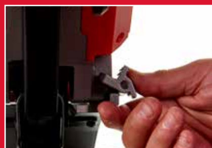
Ограничитель глубины реза с регулировкой позволяет пользователю делать несквозные резы
