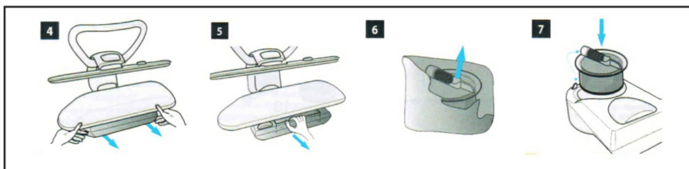
Взявшись с обоих сторон за бак для воды, тяните на себя, пока сверху не откроется отверстие для заполнения воды (рис. 4). Вытяните бак полностью (рис.5). Если Вам нужно менять картридж на новый, то поверните старый картридж налево до упора и выньте его.
