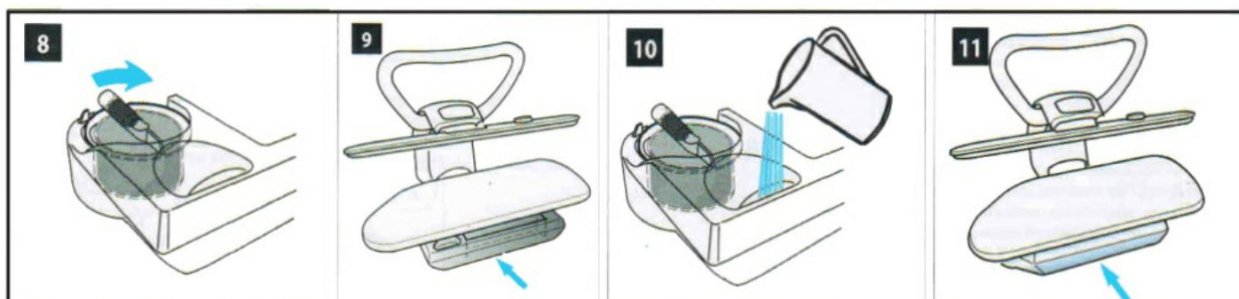
Поверните картридж направо до упора (рис.8). Вставьте бак обратно и заполняйте водопроводной или дистиллированной водой (рис. 8,10). Надавите бак на место до упора (рис. 11). При необходимости бак можно заполнять водой в процессе глажения
