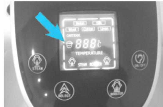
Для разблокировки парообразования нужно либо поменять картридж, либо использовать дистиллированную воду для паровых приборов.
