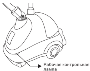
По горячей контрольной лампе можно легко увидеть, что прибор работает
