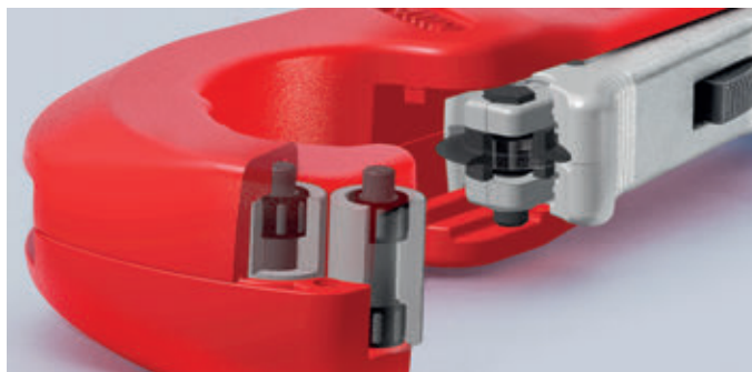
Высококачественные игольчатые подшипники позволяют режущему диску и четырем направляющим роликам работать без какого-либо раздражающего трения — рез труб из нержавеющей стали без малейших усилий
