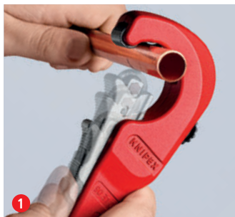
1 Поместите трубу в раскрытый труборез KNIPEX TubiX® ...
