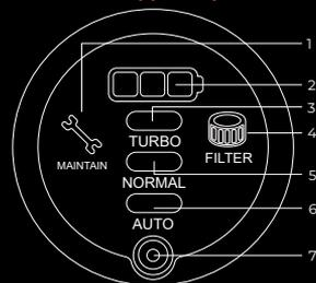
1. Индикатор блокировки всасывающего отверстия
