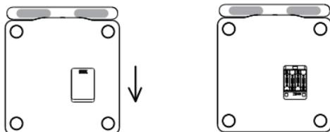
2. Вставьте в отсек элементы питания (4 батарейки типа AA) в соответствии с полярностью. Закройте отсек для элементов питания, установив крышку и сдвинув ее плавным движением в направлении, указанном на картинке, до щелчка.
