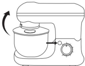
2. Снимите чашу с продуктами. Для этого поверните ее до упора против часовой стрелки и извлеките.
