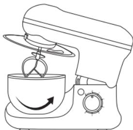
3. Извлеките использованную насадку (венчик для взбивания, крюк для замешивания теста, насадку для смешивания). Для этого слегка нажмите на насадку вверх, поверните ее по часовой стрелке и снимите с оси.
