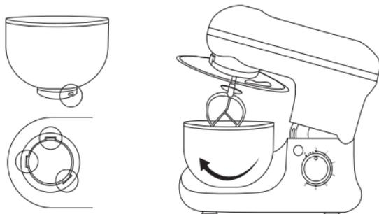
5. Приподнимите рабочую часть, нажмите на кнопку фиксации рабочей части (6) и опустите рабочую часть вниз, чтобы закрепить ее в рабочем положении.
