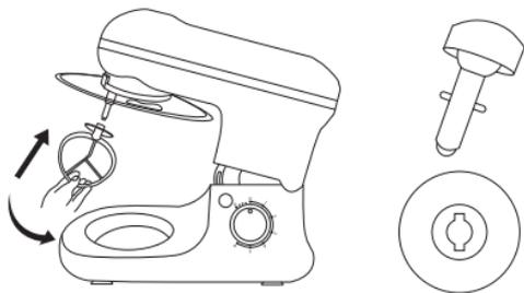
4. Поместите чашу с продуктами для смешивания в отсек для чаши (3), совместив выступы на чаше с выемками в отсеке. Плотно зафиксируйте чашу, повернув ее до упора по часовой стрелке.
