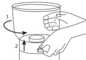
3. Извлеките жернов из блока для помола, повернув его против часовой стрелки и потянув вверх.
