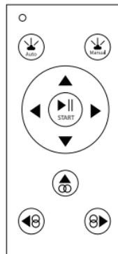
– нажатие на кнопку включает/выключает автоматический режим распыления воды
