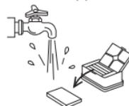
3. Хорошо просушите все детали, установите фильтрующую губку на место и закройте сетчатую крышку.
