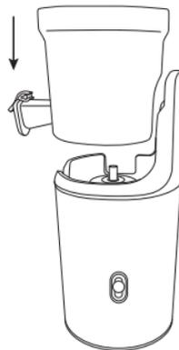
2. Установите шнек в чашу. Следите, чтобы он плотно насадился на ось, в противном случае загрузочный лоток не установится сверху.
