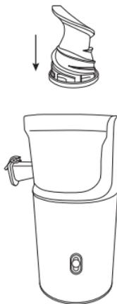
3. Установите загрузочный лоток так, чтобы выступ на его задней части оказался рядом с замком на чаше. Поверните лоток по часовой стрелке до щелчка, чтобы закрепить.
