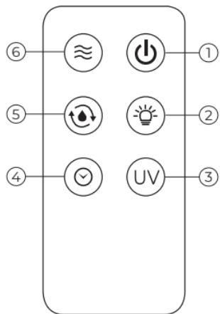
1. Кнопка «Вкл/Выкл» . Включает/выключает прибор.
