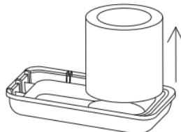
4. Промойте под проточной водой водяной фильтр и поддон.
