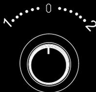
Положение регулятора **0** – прибор выключен
