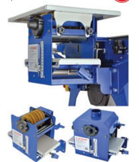
Устройство предназначено для браширования деревянных заготовок. Имеет два рабочих стола. Устанавливается вместо штатного фрезерного стола. Применяется только на многофункциональных станках серии SDM. Рабочую зону браширования можно изменять по ширине. Для подключения устройства для удаления стружки имеется патрубок 63 мм.
