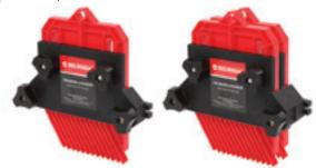
Прижимы предназначены для фиксации заготовок сверху и сбоку при фрезеровании. Устанавливаются в паз параллельного упора или рабочего стола. Благодаря наклонным пластиковым «перьям» создается постоянное усилие, прижимы не оставляют следов на заготовке.
