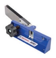
Устройство используется в качестве дополнительного приспособления для работы на циркулярных/ круглопильных станках. Предназначено для выполнения угловых пазов шипа. Устанавливается на большинство имеющихся на рынке видов циркулярных станков со стандартным Т-образным пазом. Допустимое расстояние от центра паза до пильного диска – от 57 до 114 мм.
