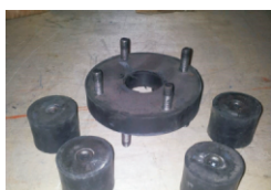
Оснащена центральными и боковыми амортизаторами (всего 5 шт.)
