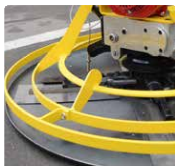
Затирочный диск с защитным кольцом
