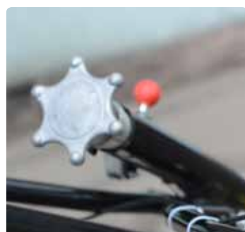
Рычаг регулировки наклона лопастей
