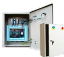
АВР применяется для ДГУ, работающих в резервном режиме. АВР обеспечивает запуск и подключение ДГУ (при пропадании электропитания от основного источника энергии), а при появлении электропитания от основного источника переключение нагрузки на него и выключение ДГУ в автоматическом режиме.
