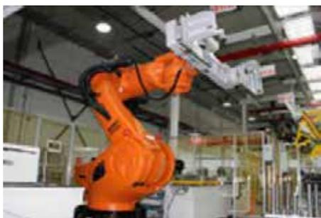
Робот «КУКА» для нанесения герметика
