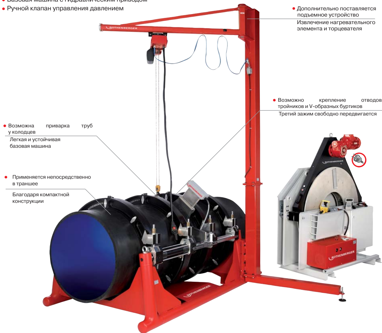
Прочное электрическое подъемное устройство
