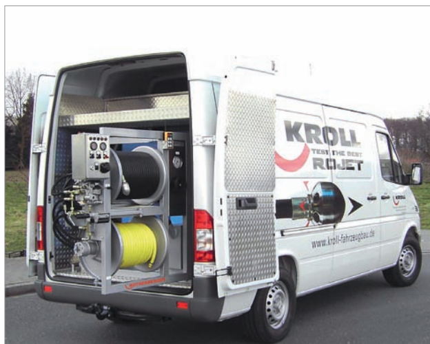
Комфортное исполнение - поворотный держатель для барабана
