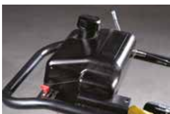
Прочный пластмассовый масляный бак не ржавеет и имеет долгий срок эксплуатации
