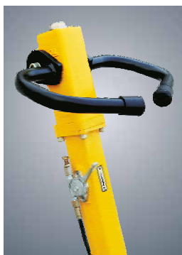
Гидравлические рычаги регулировки позволяют легко менять управление
