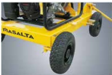
4 резиновых колеса обеспечивают устойчивость при передвижении конструкции
