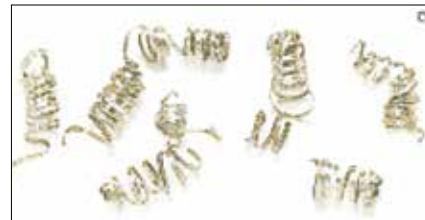
Свободно намотанная (витая) стружка – идеальные условия резания
