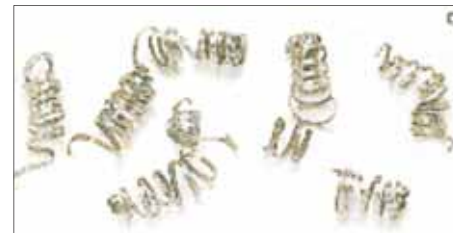
Свободно намотанная (витая) стружка – идеальные условия резания
