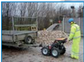
ТЯГОВО-СЦЕПНОЕ УСТРОЙСТВО устройство для буксировки тяжелых прицепов
