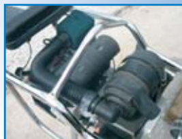
RT66/RT74 GX120 Honda со двоянным воздушным фильтром (дополнительная опция)
