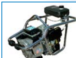
RT66 Robin EH12D со двоянным воздушным фильтром
