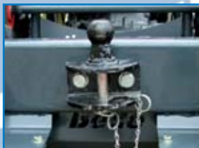
ТЯГОВО-СЦЕПНОЕ УСТРОЙСТВО устройство для буксировки тяжелых прицепов
