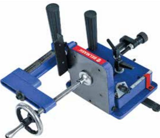
Устройство используется в качестве дополнительного приспособления для работы на циркулярных/ круглопильных станках. Предназначено для выполнения угловых пазов шипа и заплечиков. Устанавливается на большинство имеющихся на рынке видов циркулярных станков, у которых на рабочем столе предусмотрен торцевой паз. Допустимое расстояние от центра паза до пильного диска – от 57 до 114 мм.
