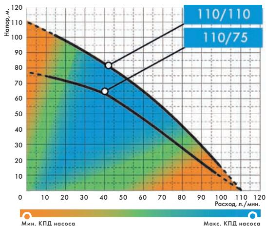
\* Заявленные характеристики были получены при испытании насосов в холодной воде без газа и абразивных примесей, а также напорной магистралью внутренним диаметром 1½" при напряжении 220 В.
