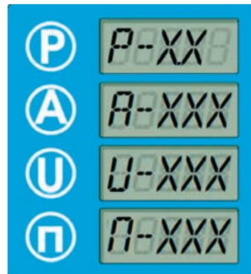
Основным режимом является индикация **P-X.X** давления в водопроводной сети, при нажатии кнопки **U** индикатор переходит в режим индикации **U-XXX** напряжения на DC шине, при нажатии кнопки **A** индикатор переходит в режим индикации **A-XXX** потребляемого тока, при нажатии кнопки **П** индикатор переходит в режим индикации **П-XXX** коэффициент загрузки электродвигателя. Индикация напряжения и тока длится 20 секунд, затем индикатор переводится в режим индикации давления в водопроводной сети.
