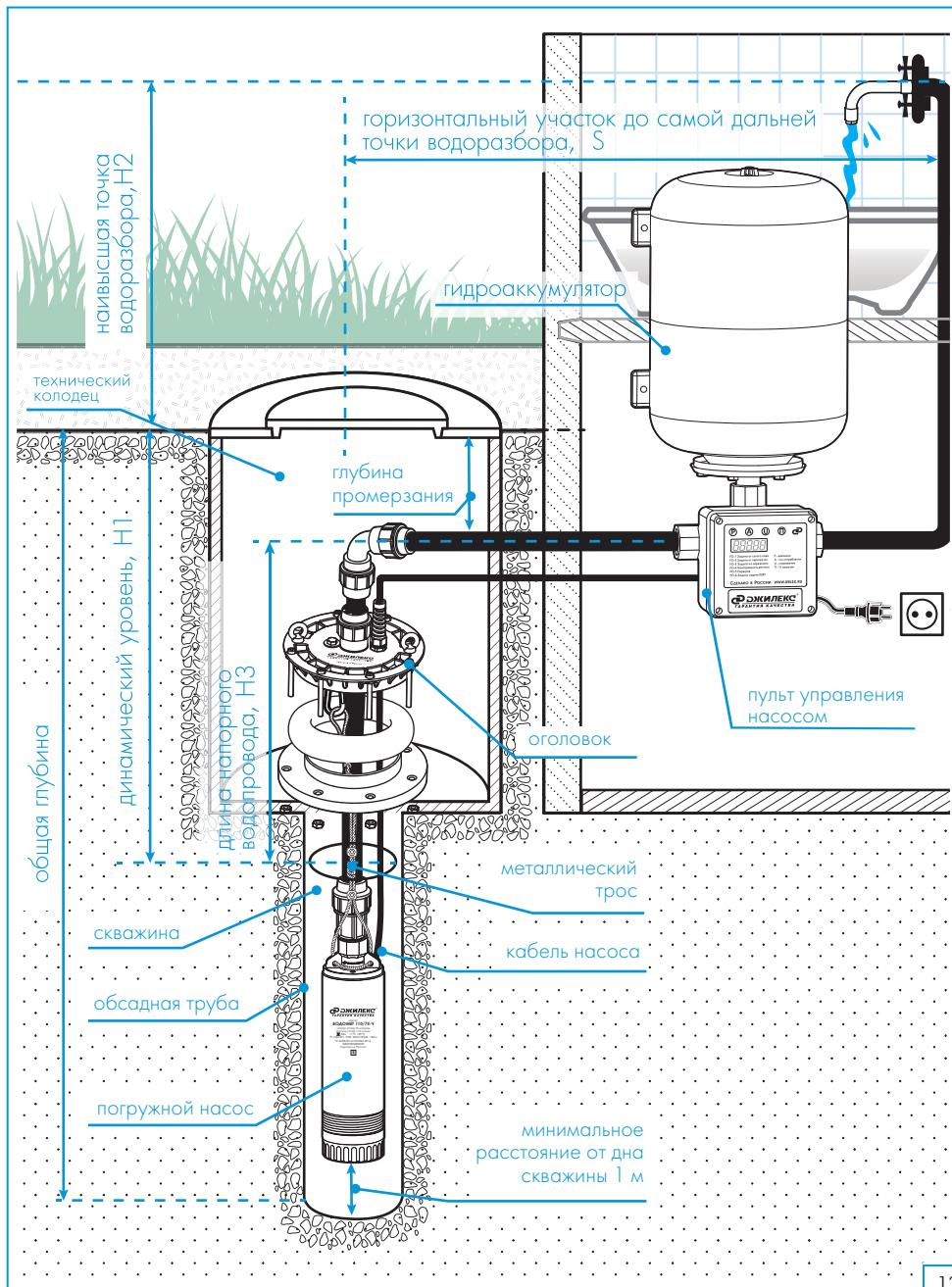
Поэтому прокачку следует производить до подключения водоподающей магистрали к домашнему водопроводу, во избежание его засорения.
