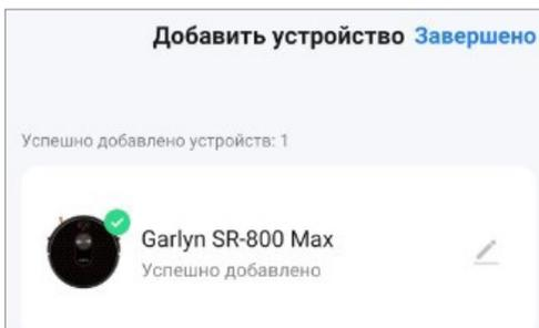
8. Нажмите на устройство, чтобы войти на страницу настроек. Здесь Вы сможете управлять прибором дистанционно, поставить виртуальную стену, установить карту уборки, выбрать один из пяти языков голосового сообщения, проверить процесс/статус и многое другое.
