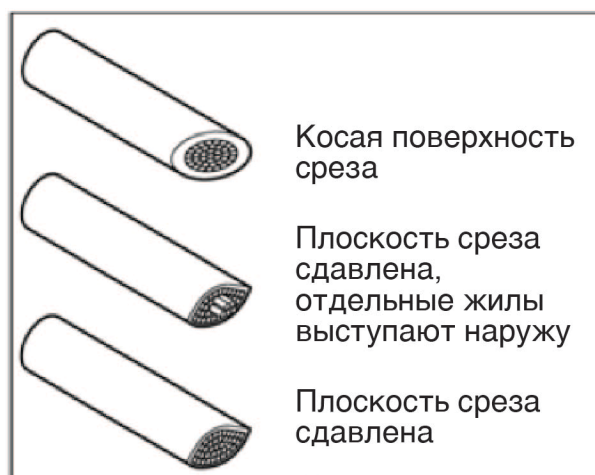
Рис. 11 Неправильная резка провода
