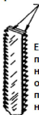
Если для обрезки полотна используются ножницы, отшлифуйте торцы полотна, как показано на рисунке.
