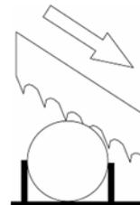
**ВНИМАНИЕ: Всегда устанавливайте на станок пыльное полотно с размерами, указанными в данной инструкции, и для которого настроены направляющие блоки. В случае установки пыльного полотна другого размера см. пункт 5.2 Регулировка хода пыльного полотна на шкивах и в направляющих блоках**
