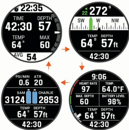
**Секундомер для дайвинга:** отображает секундомер времени на максимальной глубине; текущую, максимальную и среднюю глубину, а также скорость подъема или погружения ([Использование секундомера для дайвинга, стр. 10](#)).
