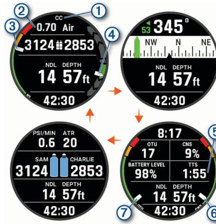
**Экран основных данных:** содержит основные данные погружения, включая дыхательный газ и скорость подъема или погружения.
