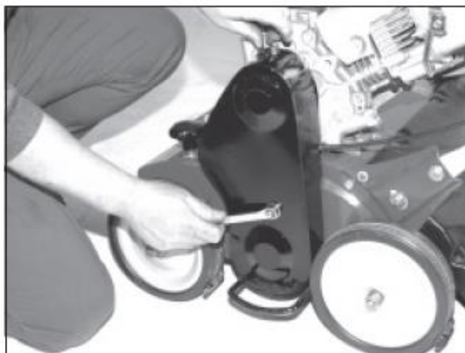
8) Затем установить и прикрутить защиту клинового ремня.
