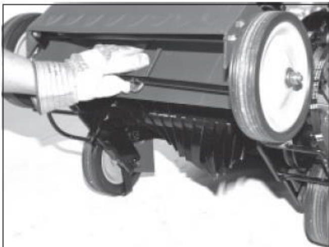
3) Приподнять узел скарификатора и навесить на крючки
