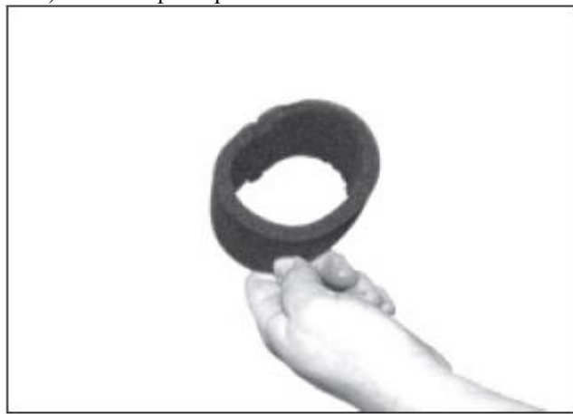
6) Осторожно выбить фильтр губой очистки или очистить сжатым воздухом.
