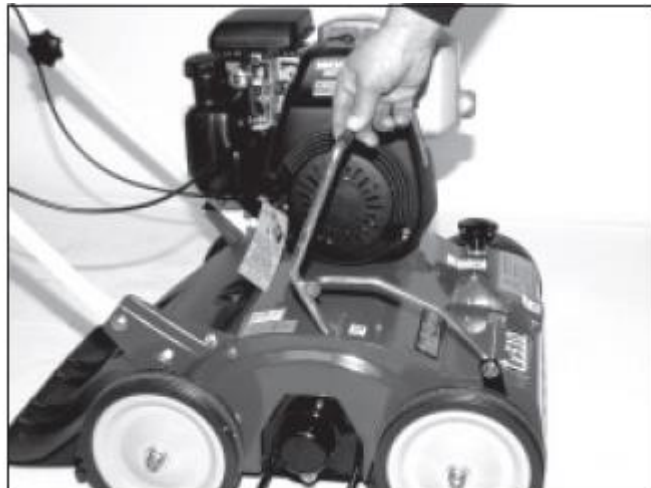
2) При нажатии на рычаг скарификатор поднимается в исходное положение.
