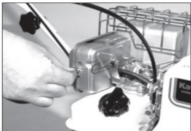
1) Ослабить болт крышки воздушного фильтра.
