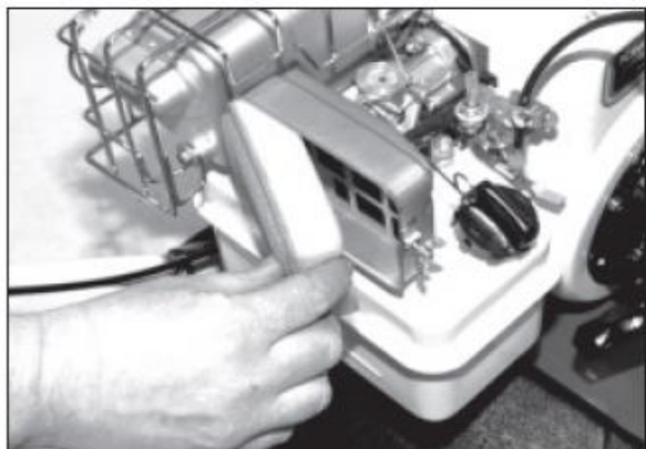
2) Извлечь фильтр. Осторожно выбить пластинки или очистить сжатым воздухом
