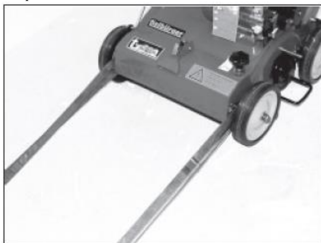
4) Передняя и задняя ось служат в качестве точек крепления. Направление натяжных ремней впереди.
