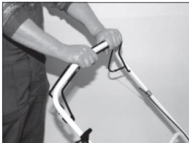
2) Привод ножей включен.
