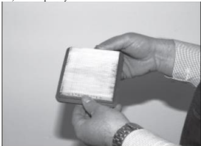
4) Осторожно выбить пластинки или очистить сжатым воздухом.
