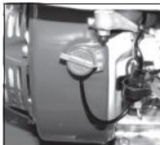
2) Установить переключатель на позицию "ON" (ВКЛЮЧЕНО)
