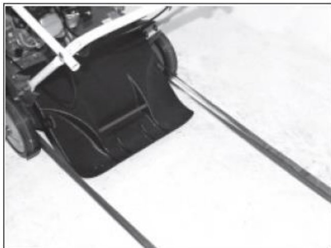
2) Перевозка автомобильным транспортом: Зафиксировать устройство натяжными ремнями. Передняя и задняя ось служат в качестве точек крепления.
