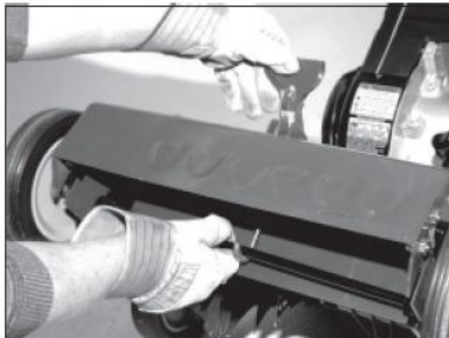
4) Затем нажать на фиксатор.
