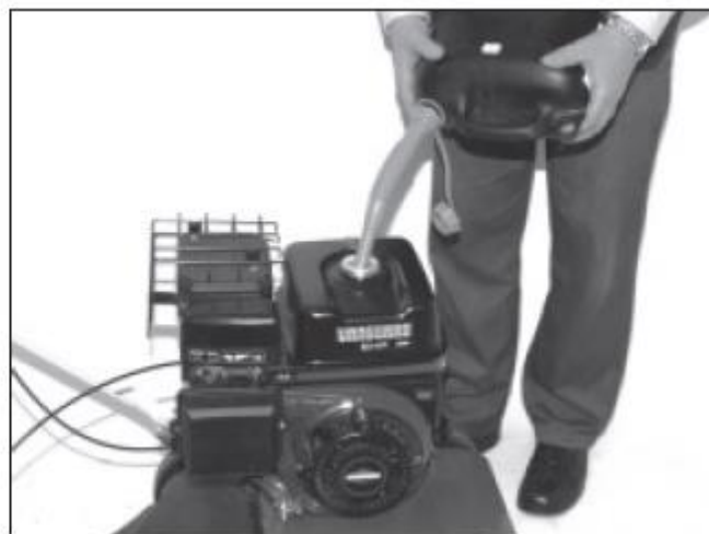
2) Нужно держать канистру, как показано на иллюстрации. Следует заливать небольшими порциями и контролировать наполнение.
