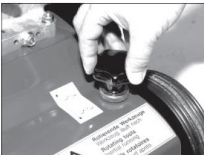
3) При поворачивании регулировочного винта устанавливается рабочая глубина.
