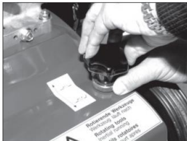
2) Сначала следует ослабить контргайку.
