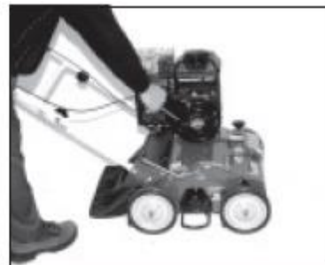
3) Потянуть за трос стартера. Следите за тем, чтобы находиться за рулем и вне опасной зоны.
