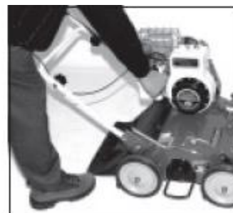
3) Потянуть за трос стартера. Следите за тем, чтобы находиться за рулем и вне опасной зоны.
