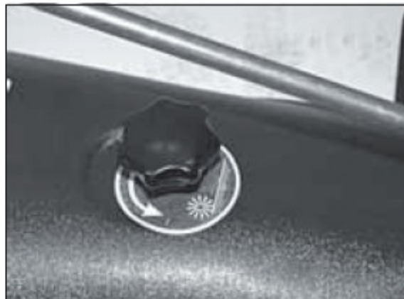
2. Ролик регулирования находится выше поддерживающего колеса
