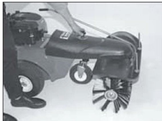
4. Опускайте щетку до тех пор пока она не коснется пола. Затем поверните ролик 3 оборота против часовой стрелки (-).
