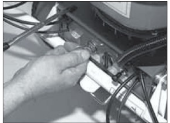
6. Запустите двигатель. Для этого поверните ключ зажигания на короткий период времени направо и затем отпустите.
