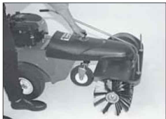
4. Опускайте щетку до тех пор пока она не коснется пола. Затем поверните ролик 3 оборота против часовой стрелки (-).
