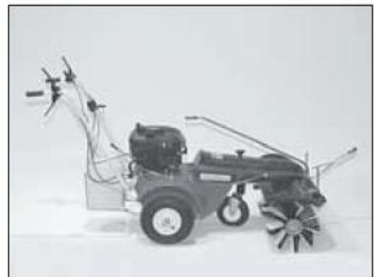
6. Подметальная машина с установленным водным распылителем готова к работе.
