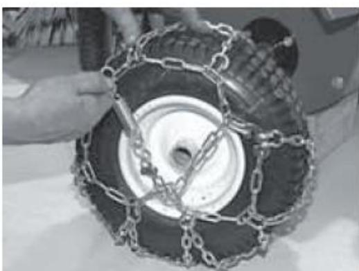
5. Сожмите конец цепи при помощи пружины и закрепите. Пружина должна быть слегка натянута.
