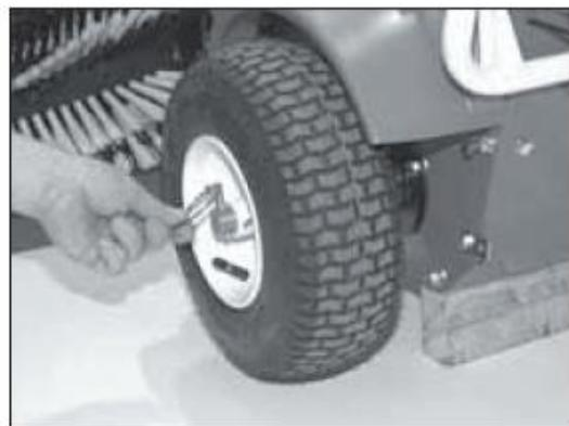
2. Сначала поднимите машину на деревянных блоках и затем снимите колесо.
