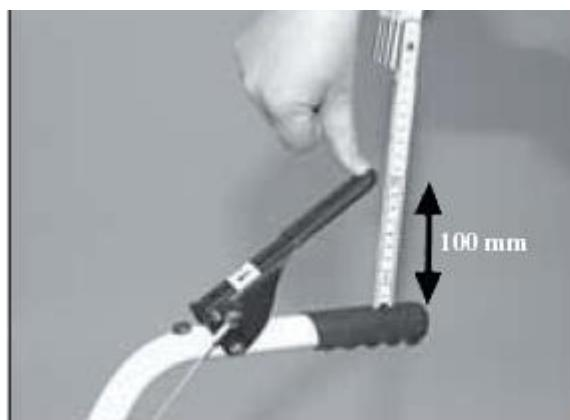
3. Проверьте сделанную Вами настройку, придавливая рычаг. После 100мм свободного хода Вы должны почувствовать сопротивление. Если неправильно отрегулировано, пожалуйста, повторите шаги 1 и 2.
