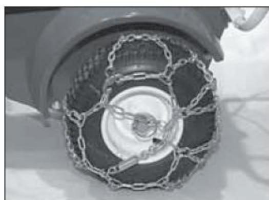
6. Наденьте колесо с цепью на ось и закрепите его шплинтом. Повторите процедуры для второго колеса.
