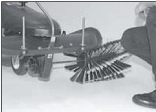
3. Снимите ось вместе со второй частью щетки.
