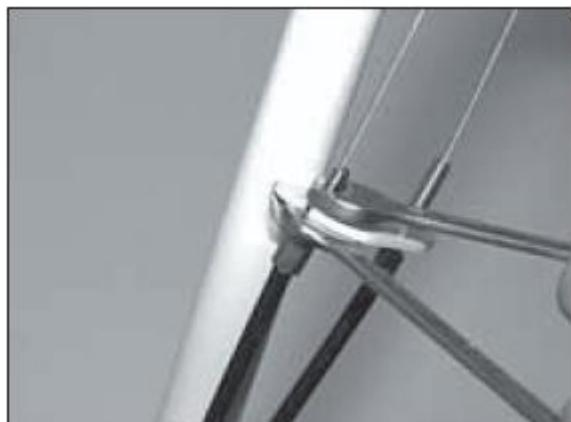
1. Ослабьте верхнюю гайку с накидным гаечным ключом на 10 мм (приблизительно один поворот).
