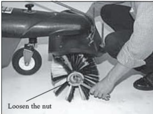
1. Ослабьте гайку на левой щетке при помощи накидного гаечного ключа на 19 мм.
