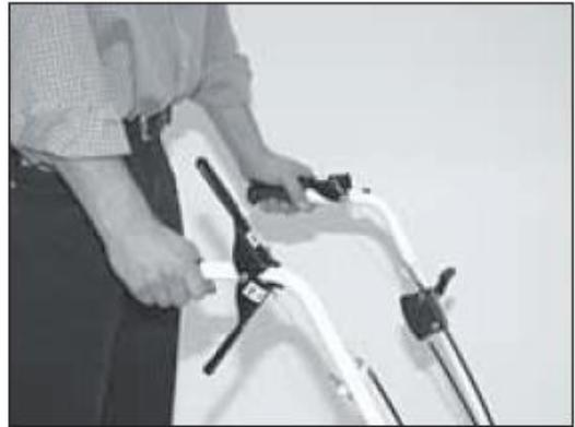
1. Рычаги выключателя привода колес и привода щетки расположены на ручках. Задействуйте привод колес, используя правый верхний рычаг.
