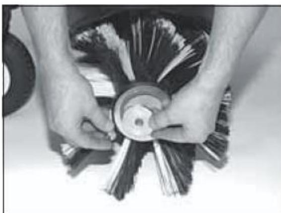
9. После установки щеток на ось, наденьте крышку и шайбу на ось.
