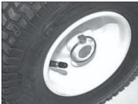
3. Отмена выбора колеса: проденьте шплинт через ось и отверстие в колпаке колеса.
