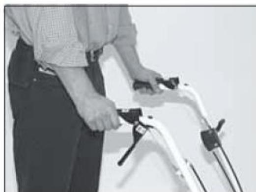
3. Если вы нажмете оба рычага, то и привод колес и привод щетки будут задействованы.
