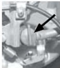
2. Если машина оснащена двигателем Хонда, топливный клапан должен быть закрыт.
