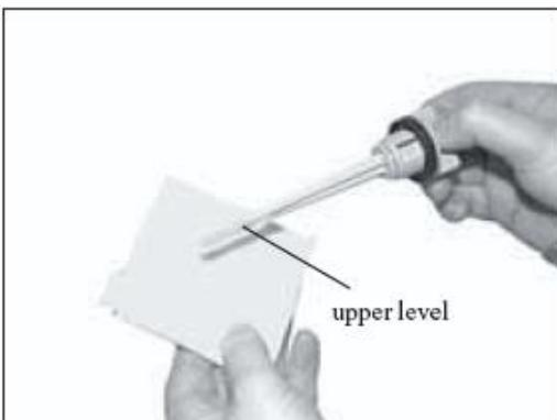
2. Щуп для измерения уровня моторного масла Хонды.
