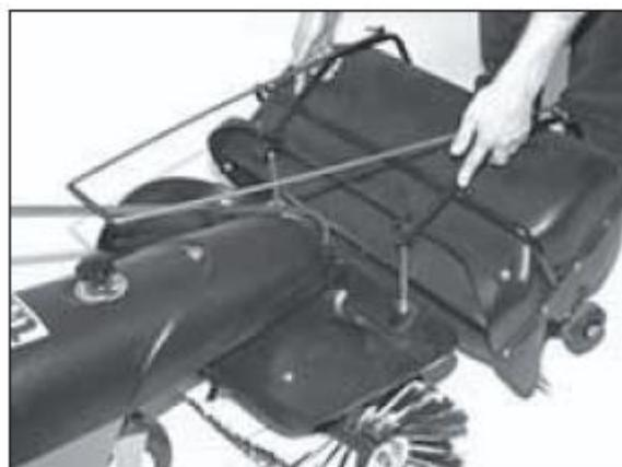
3. Вставьте соединительные втулки (2 шт) в отверстия в защитном кожухе.
