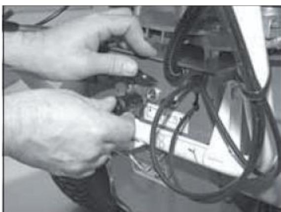
3. Поднимите крышку гнезда зарядки и подсоедините зарядное устройство.
