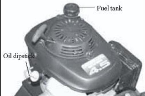
2. Топливный и масляный бак (двигатель Honda)
