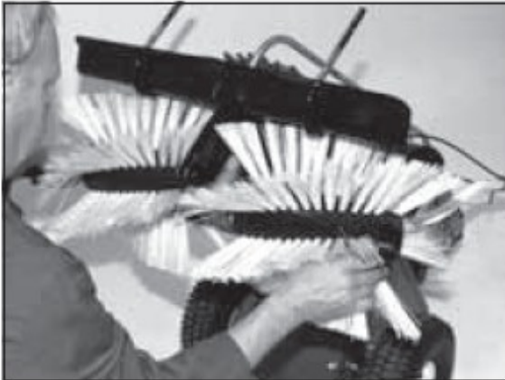
7. Подтолкните левую щетку на ось. Пожалуйста, обратитесь к предыдущим инструкциям по сборке.
