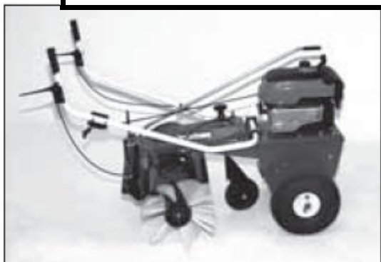
4) В целях экономии места при хранении или перемещении вы можете опустить ручки на машину.
