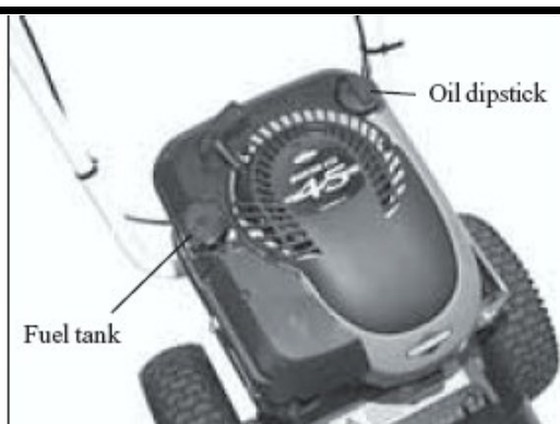
2. Топливный и масляный бак (двигатель V&S)
