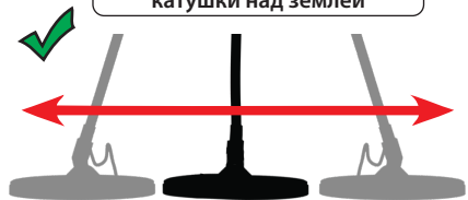
Правильный проход катушки над землёй
