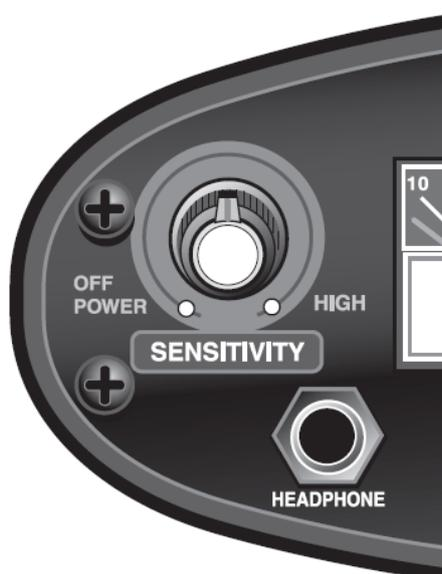
Если вам требуется оптимальная глубина обнаружения, рекомендуем работать в неселективном режиме All Metal, повернув ручку Discriminate против часовой стрелки до упора; затем поверните ручку управления чувствительностью (Sensitivity) по часовой стрелке до максимального положения, в котором ещё не будет появляться дребезжащий звук. Если Tracker IV издаёт дребезжащие звуки или нерегулярные тональные сигналы, снизьте чувствительность, повернув левую ручку против часовой стрелки.
