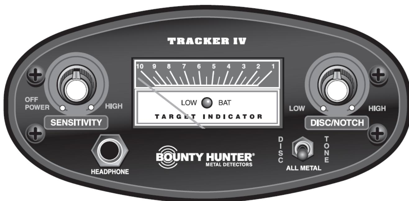
Для получения максимальной отдачи работайте с как можно более высокой чувствительностью, насколько это возможно. Обычно чувствительность можно повысить при работе в режиме максимальной дискриминации (DISC) или тонального различия (TONE).
