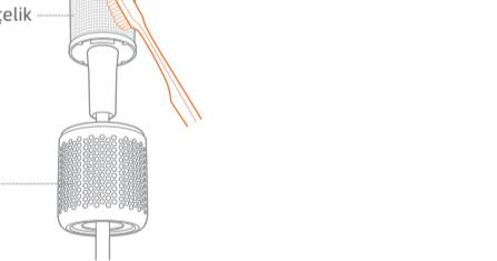
⚠ Hava akış filtresi manyetik olarak takılır. Sıpat tutun ve hava akış filtresini düz bir şekilde aşağı doğru çekerek saptanın.
