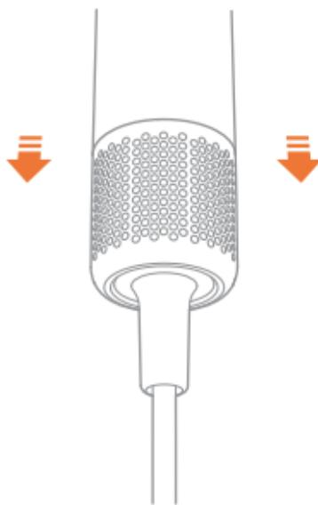
**⚠️** Non risciacquare il filtro in acciaio inox con acqua per evitare possibili malfunzionamenti.
