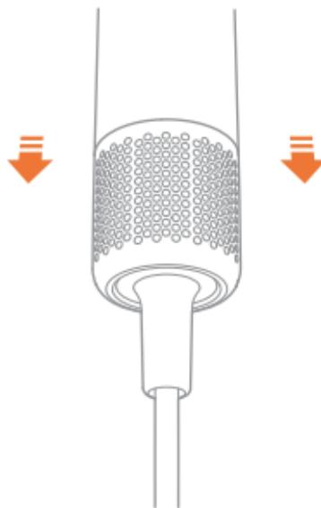
**⚠️** Ikke skyll det filteret i rustfritt stål med vann, da dette kan føre til at det ikke fungerer som det skal.
