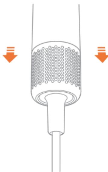
⚠ Skölj inte filtret av rostfritt stål med vatten eftersom det kan göra att det inte fungerar korrekt.
