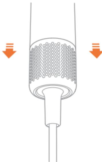
**⚠** Spoel het roestvrijstalen filter niet af met water. Hierdoor kan het mogelijk niet goed werken.
