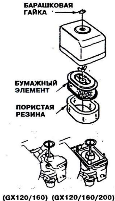
Загрязненный фильтр затруднит приток воздуха в карбюратор. Во избежание неисправностей в работе карбюратора, регулярно чистите фильтр. Делайте это чаще, если двигатель работает на пыльных территориях.
