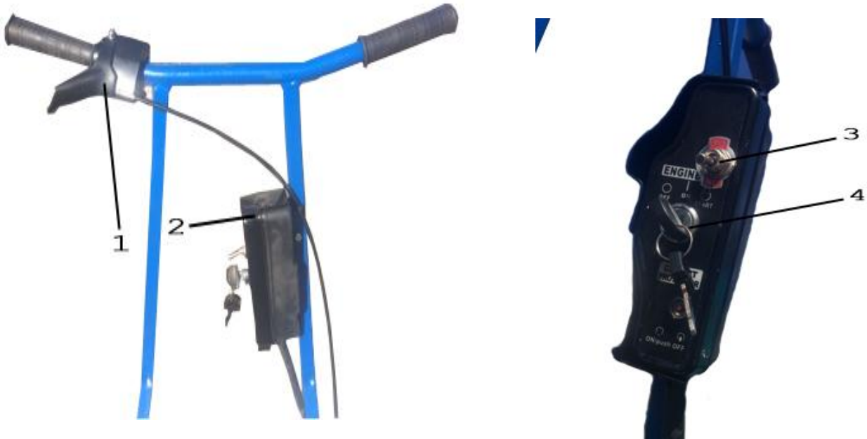
1) Рычаг газа; 2) Блок зажигания; 3) Кнопка «Фара»; 4) Замок зажигания;
