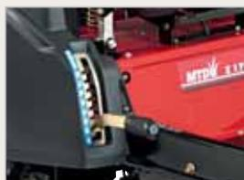
РУЧНАЯ РЕГУЛИРОВКА ВЫСОТЫ СКАШИВАНИЯ И ЭЛЕКТРИЧЕСКОЕ УПРАВЛЕНИЕ ВКЛЮЧЕНИЕМ НОЖЕЙ
