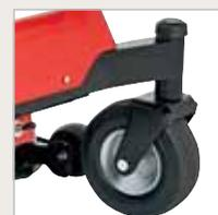
ПЕРЕДНИЕ ПНЕВМАТИЧЕСКИЕ КОЛЕСА РОЛЯЛЬНОГО ТИПА
