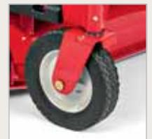
ПЕРЕДНИЕ РОЛЯЛЬНЫЕ КОЛЕСА, ОБЕСПЕЧИВАЮЩИЕ НУЛЕВОЙ РАДИУС ПОВОРОТА
