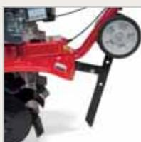
ПРИ ПЕРЕВОДЕ МАШИНЫ В РАБОЧЕЕ СОСТОЯНИЕ ФИКСАТОР КОЛЕС ПРЕОБРАЗУЕТСЯ В СОШНИК С РЕГУЛИРУЕМОЙ ГЛУБИНОЙ (ТОЛЬКО НА МОДЕЛЯХ T/205 И T/245)
