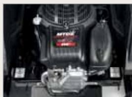
МОЩНЫЙ ДВИГАТЕЛЬ MTD С ДВОЙНОЙ ГИДРОСТАТИЧЕСКОЙ ТРАНСМИССИЕЙ ПОЗВОЛЯЕТ ВЫПОЛНЯТЬ ПОВОРОТ С НУЛЕВЫМ РАДИУСОМ
