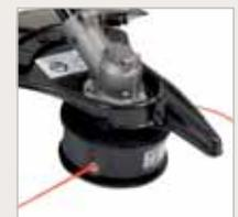
2,0-2,4 мм, ДВОЙНАЯ ЛЕСКА И ГОЛОВКА НАЖИМНОГО ТИПА НА ВСЕХ МОДЕЛЯХ
