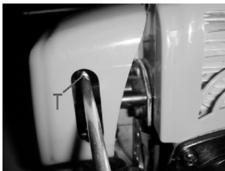
T = Винт регулировки холостого хода
