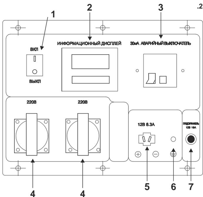
1. Выключатель двигателя ВКЛ/ВЫКЛ
