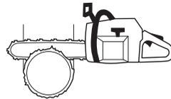
Существуют методы валки деревьев с полотном, меньшим диаметра ствола. Однако эти методы достаточно опасны, т.к. область отдачи полотна входит в контакт с предметом.
