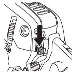
Остановка двигателя осуществляется нажатием на выключатель запуска/остановки.
