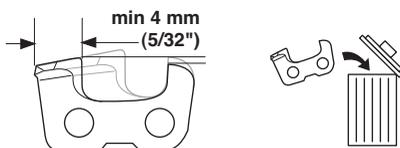
Общие сведения относительно снижения ограничителя глубины врезания.
