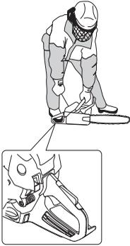
Так как тормоз цепи по-прежнему включен, двигатель должен как можно скорее быть переведен на холостые обороты, что может быть достигнуто за счет быстрого выключения ограничителя газа. Тем самым Вы избежите ненужного износа сцепления, барабана сцепления и тормозной ленты.
