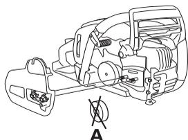
Установите пильное полотно на специально предназначенные болты. Установите полотно в самое заднее положение. Оденьте цепь на ведущую звездочку и вставьте ее хвостовики в паз пильного полотна. Начинайте с верхней стороны пильного полотна.
