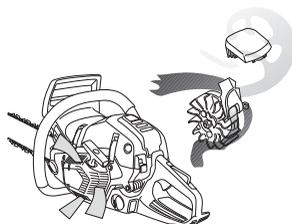
**ВАЖНО!** Для осуществления метода центробежной очистки нужно постоянно выполнять техническое обслуживание и уход за системой. Необходимо чистить воздухозаборник стартера, лопасти вентилятора на маховике, пространство вокруг маховика, входного коллектора и карбюратора.
