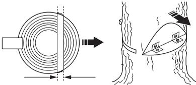
Возможность влияния на направление падения будет полностью утрачена, если полоса разлома слишком узкая или пропилована направляющий и основной пропилов плохо размещены.
