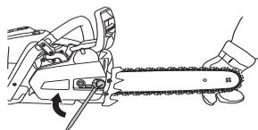
При установке новой цепи следует часто проверять ее натяжение, пока цепь не приработается. Регулярно проверяйте натяжение цепи. Правильно натянутая цепь обеспечивает высокое качество пиления и дольше служит.
