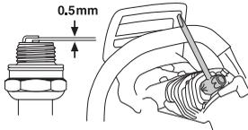
Обратите внимание! Всегда используйте только указанный тип свечи! Применение несоответствующей модели может привести к серьезным повреждениям поршня/цилиндра. Следите за тем, чтобы свеча была оснащена т.н. изоляцией радиопомех.
