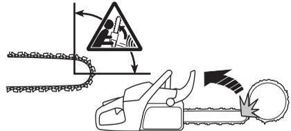
Отдача всегда происходит в плоскости резания пилы. Обычно при отдаче моторную пилу отбрасывает назад и вверх в направлении рабочего. Тем не менее моторная пила в момент отдачи может двигаться в различных направлениях в зависимости от метода резки, который применялся в момент касания зоны отдачи полотна и объекта.
