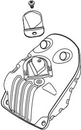
Глушитель служит для снижения уровня шума и отвода раскаленных выхлопных газов от рабочего. Выхлопные газы очень горячие и могут содержать искры, что может привести к пожару при прямом попадании на сухой и воспламеняющийся материал.
