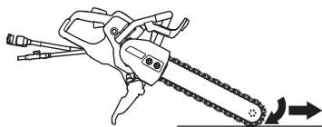
Не передвигайте машину, если резчик вращается. Гироскопические силы могут затруднить движение в выбранном направлении.
