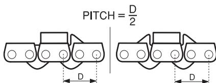
При использовании цепи с двойными амортизаторами приводных звеньев ее можно устанавливать в обе стороны.
