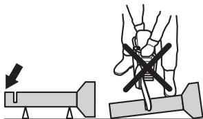
Kui torul lastakse rippu jääda ja lõikesoon kinni suruda, kiilub juhtplaat tagasilöögisektoris kinni ja võib põhjustada tugeva tagasilöögi. Kui toru on korralikult toestatud, liigub toru ots allapoole, avades lõikesoone ja võimaldades sujuvat lõikamist.
