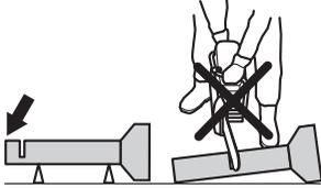
В случае если позволить трубе провиснуть и закрыть отверстие, полотно будет занато в зоне отдачи, что может привести к сильной отдаче. Если обеспечена правильная опора, концы труб переместятся вниз и пропилен раскроется, предотвращая заклинивание режущего диска.
